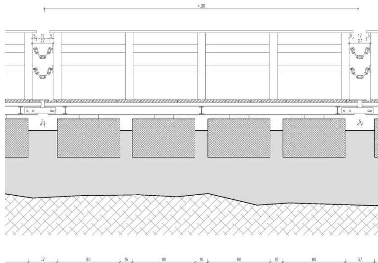
Eintauchtiefe unter Volllast  $2,5 \text{ kN/m}^2 = 35 \text{ cm}$
