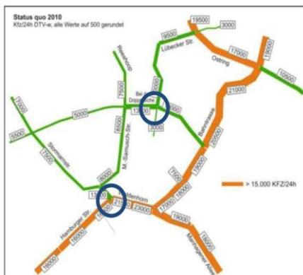
Abb. 50 Problematische Knoten für Fuß- und Radverkehr (Quelle: GGR 2016)
