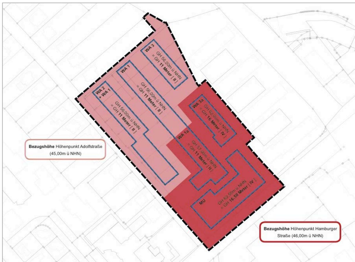
Abb. 15 Schematische Darstellung der festgesetzten Höhen mit Bezugspunkten, o.M.
