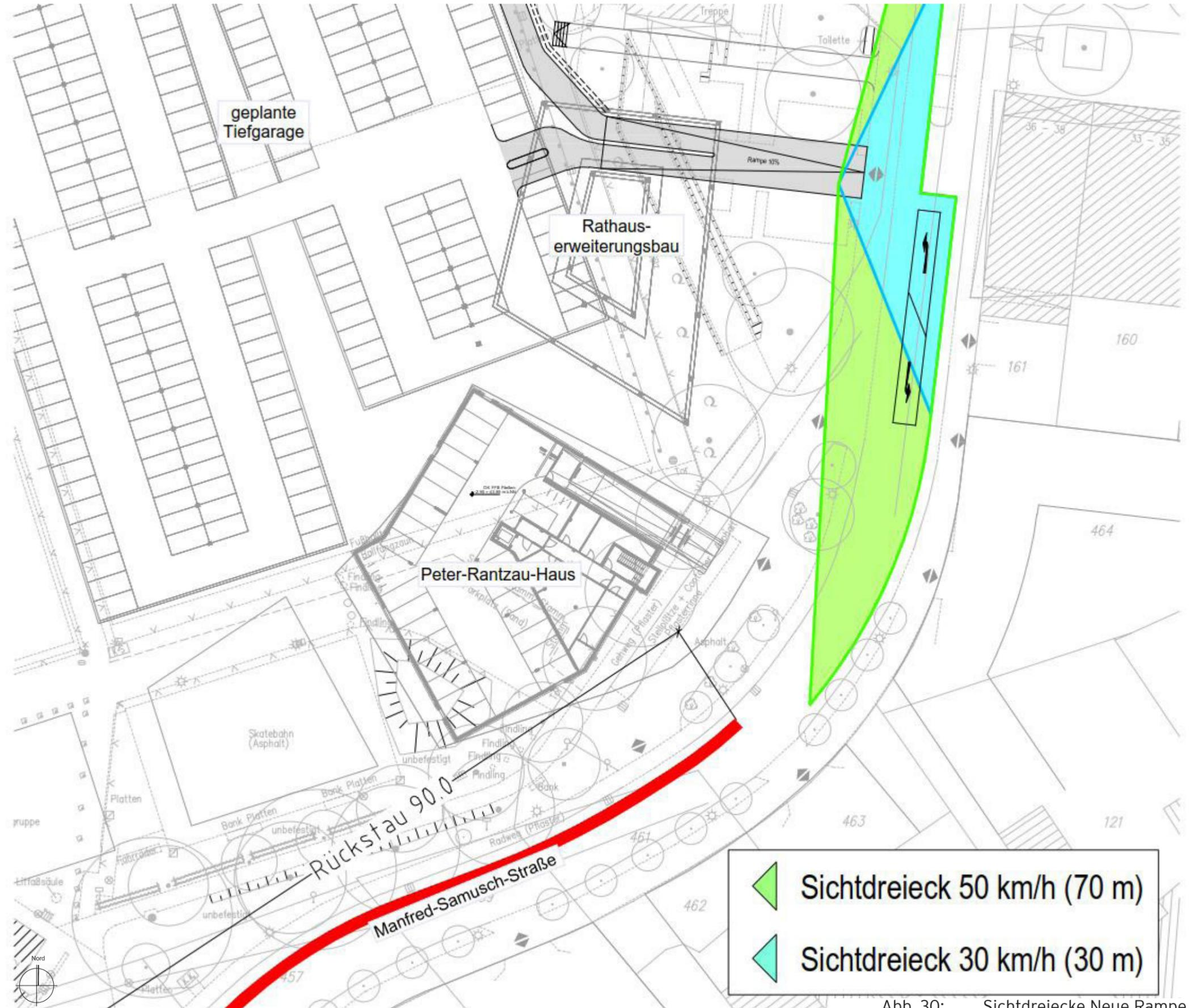
Abb. 30: Sichtdreiecke Neue Rampe
