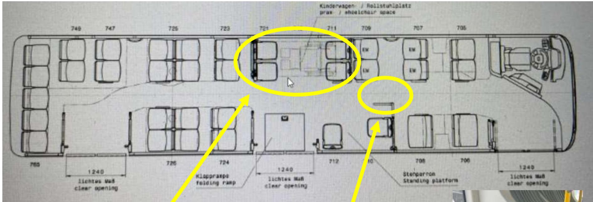
Genauere Anordnung der Klappsitze noch in Abstimmung; voraussichtlich werden diese an der Bordwand also quer zur Fahrtrichtung angebracht
