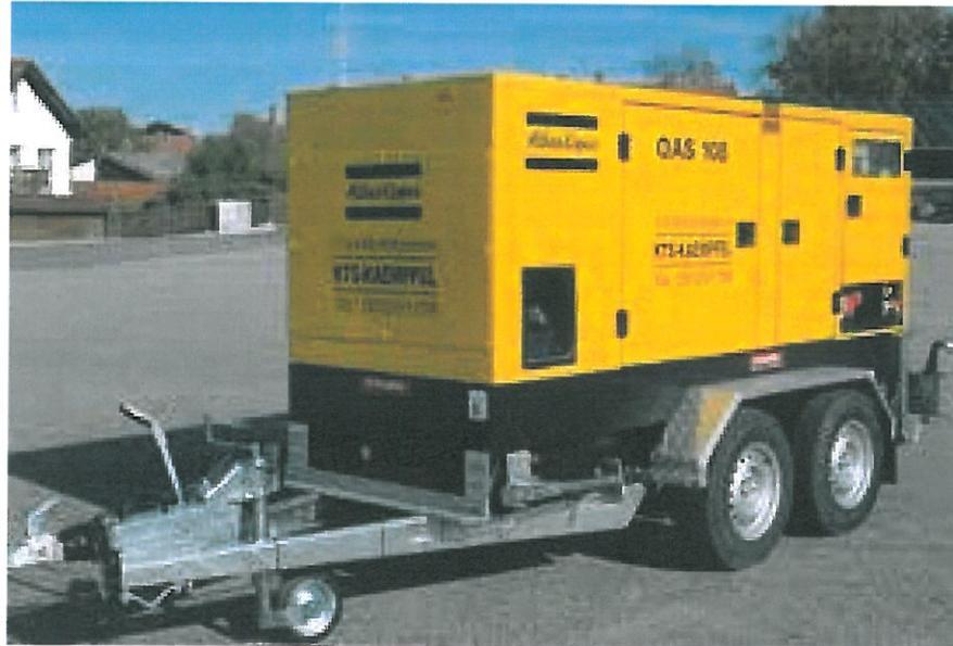
Mobiles Notstromaggregat zur kurzfristigen Versorgung (z.B. Baustelle, Veranstaltung, Hilfeinsatz). Im Falle eines Stromausfall muss das Aggregat mit einem geeigneten Fahrzeug verbracht werden. Aufstellung in Tiefgarage aufgrund der Abgasführung nicht möglich. Aufstellung im Außenbereich nicht überwachbar.
